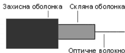
Рис. 4.6. Будова оптоволоконного кабелю.
