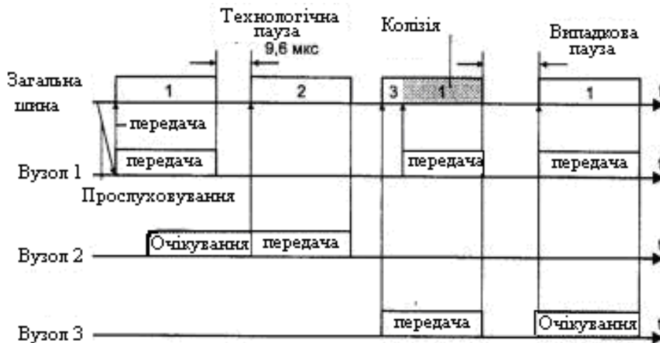
Рис. 7.1. Метод випадкового доступу CSMA/CD Етапи доступу до середовища
