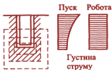
Рис.2 "Витіснення" струму у верхню частину стержня
