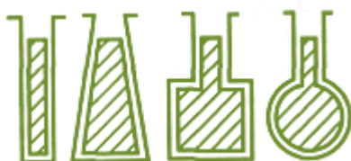
Рис.3 Стержні ротора з глибоким пазом
